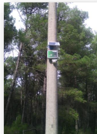
B-Sentinel - Esempio di montaggio a palo all'interno di un'area boschiva
