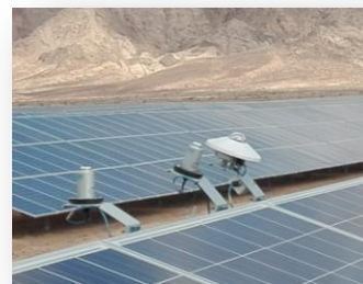
Particolare dei piranometri (a termopila e a cella di silicio)
