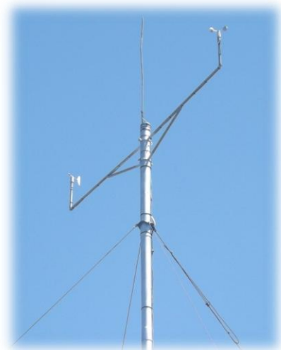
Tipica installazione per applicazioni eoliche conformi IEC61400-12
