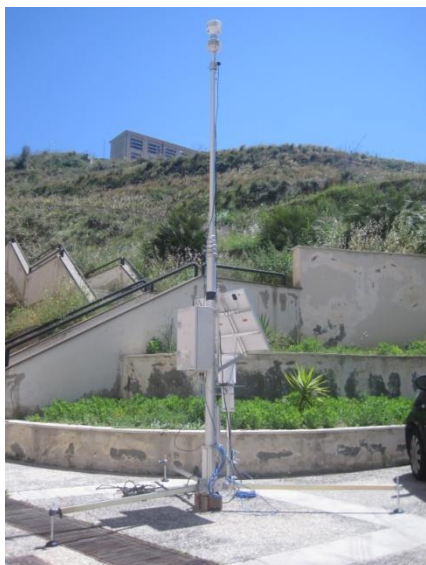
PTAP6-80 - Palo pneumatico h=6m con treppiede e anemometro sonico multiparametrico con bussola integrata
