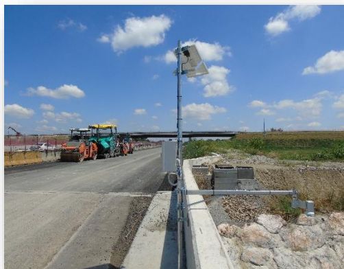
Palo telescopico h=3m mod. PF3-55 per applicazioni idrometriche
