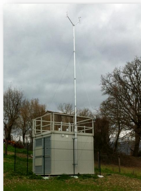
PTAP10-80 - Palo pneumatico h=10m, con pompa manuale o compressore aut., per cabina qualità aria.
