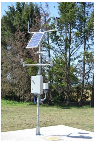
PF4-55 - Palo telescopico h=4m con piastra per platea in cls
