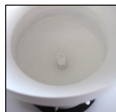
Vista del filtro e del cono di raccolta delle precipitazioni
