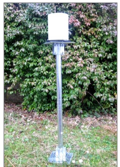
Installazione del pluviometro sollevato da terra con supporto cod. SPL100 (h=100cm, ø45mm)
