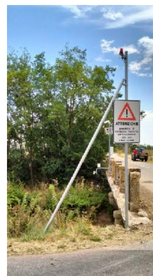
Esempi di installazione con pali da 3m (con web-cam, pluviometro e lampada di segnalazione di pericolo)
