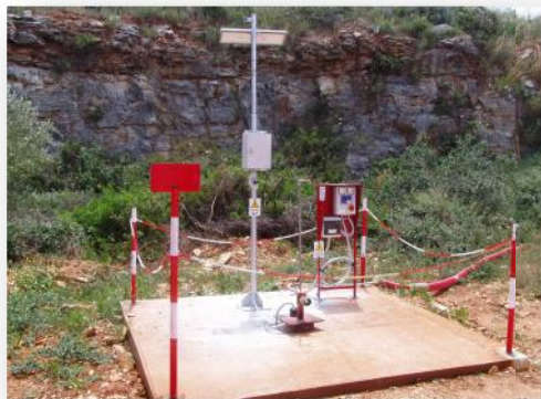
Stazione monitoraggio acque sotterranee in discarica
