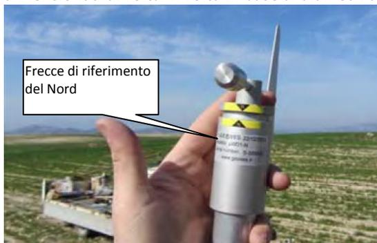
Il fissaggio del sensore di direzione vento modello mWD1 deve essere effettuato orientandolo correttamente a Nord. Tale operazione viene eseguita come segue:
