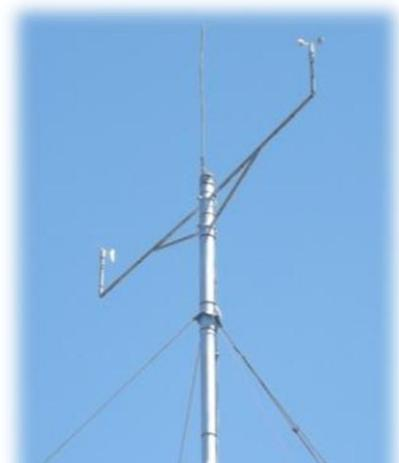
Tipica installazione per applicazioni eoliche conformi IEC61400-12
