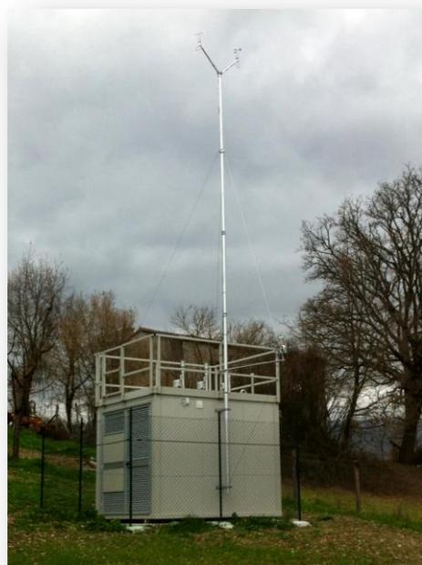
Palo meteo h=10m mod.PTAP10-80 conforme WMO per applicazioni di monitoraggio ambientale
