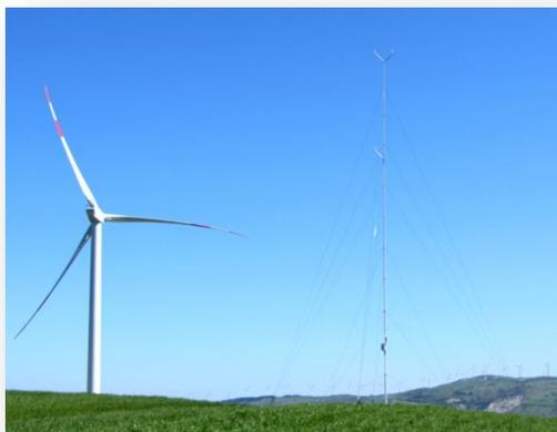
Palo anemometrico h=20m mod. PRF20-60 per applicazioni eoliche conforme IEC61400-12
