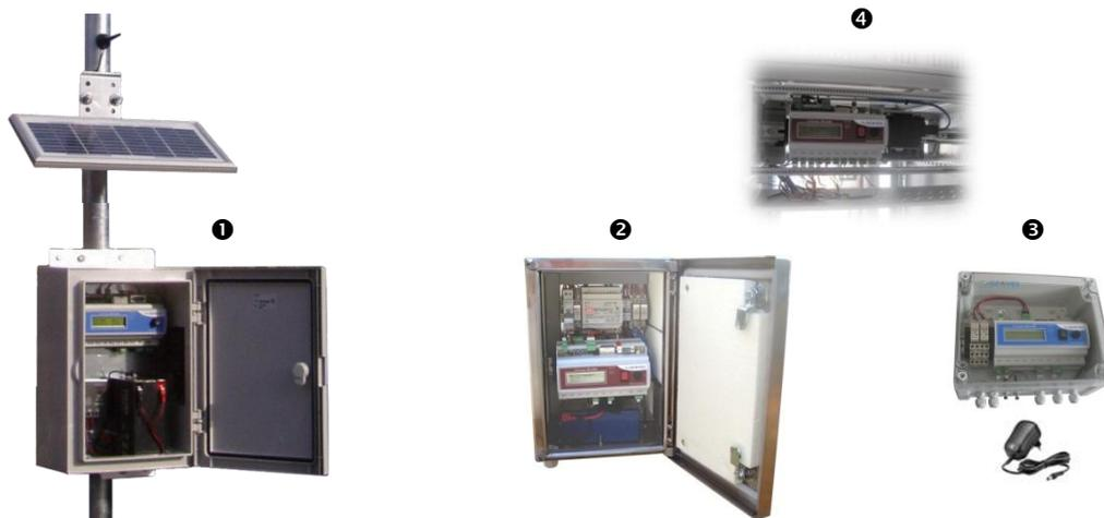
Esempi di scatole stagne di alloggiamento dei datalogger Micro3 (1 - poliestere rinforzato, 2 - acciaio inox, 3 - plastica con coperchio trasparente, 4 - rack 19") e varie tipologie di alimentazione (pannello fotovoltaico, rete 220Vac con batteria tampone, rete 220Vac con alimentatore da parte
