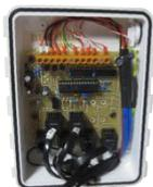
**Int-ISS** Modulo interfaccia sensori ISS cablato Davis per collegamento a datalogger Micro serie 3 Geoves
