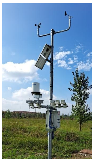
Installazione del pluviometro su palo meteo con sbraccio a L cod. SPL-L
