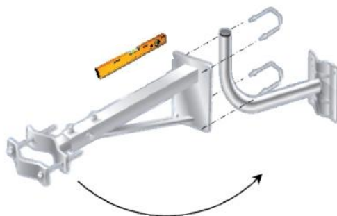
Figura 1 – Rotazione della staffa SID150 per idrometro con staffa SID75
