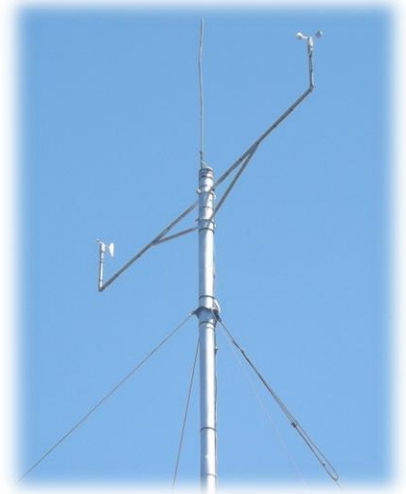
Tipica installazione per applicazioni eoliche conformi IEC61400-12
