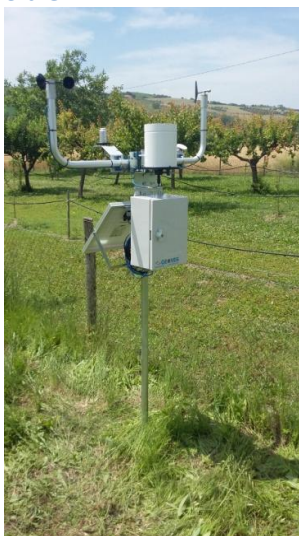
PF2-40 – Palo leggero h=2m con fissaggio su puntale a vite (senza opere edili)
