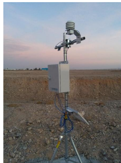
PL2-TREP - Palo telescopico leggero hmax=2.2m, fissaggio con picchetti su terreno o tasselli su calcestruzzo
